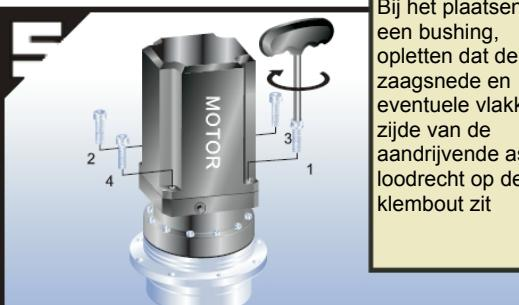
In verticale positie monteren. Motorbouten (incl. sluitringen) in volgorde 1 - 4 aandraaien tot 5 % van het voorgeschreven koppel (zie tabel 1).
