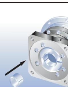
Motor as diameter controleren en indien nodig een bushing plaatsen
