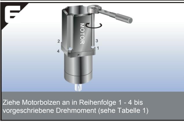
Ziehe Motorbolzen an in Reihenfolge 1 - 4 bis
