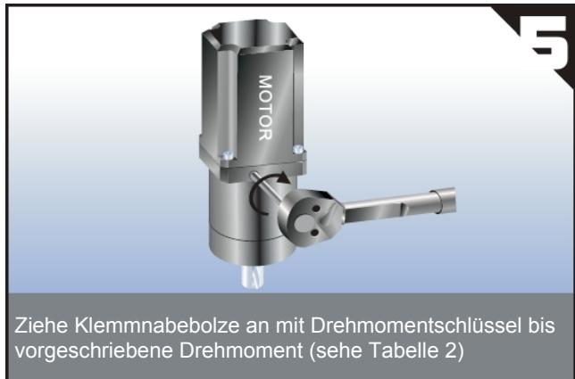
Ziehe Klemmnabebolze an mit Drehmomentschlüssel bis
