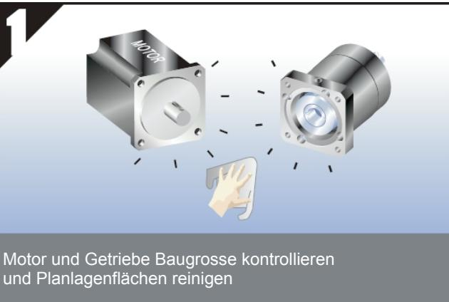
Motor und Getriebe Baugrosse kontrollieren und Planlagenflächen reinigen
