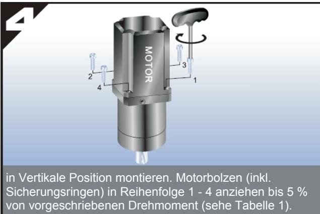
in Vertikale Position montieren. Motorbolzen (inkl.
